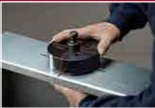
SET UP - výrazné křížky a jasný pohled na pracovní plochu umožňují rychlé a snadné vyrovnání
